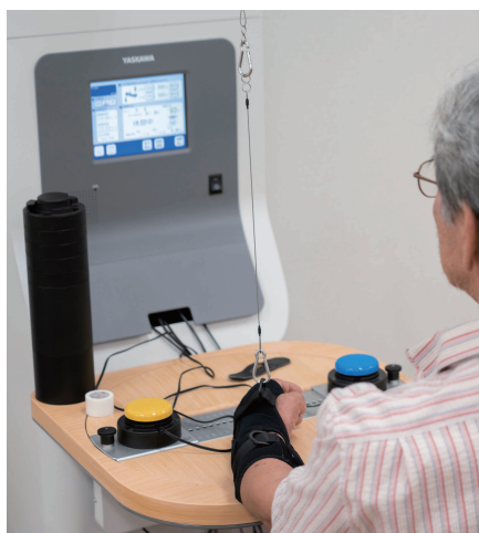
上からワイヤで腕を懸垂して電気刺激を与える。肩、肘の運動機能をサポート【CoCoroe AR2】
